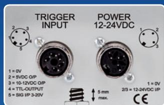
Connexions: à gauche déclencheur,
