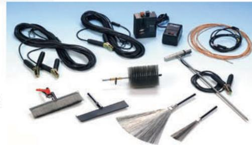
Les électrodes balai ainsi que les électrodes à spirale en acier inoxydable se caractérisent par une robustesse et une durée de vie remarquables. Toutes les électrodes peuvent également être utilisées avec les versions antérieures d'ISOTEST® et remplacées facilement.
