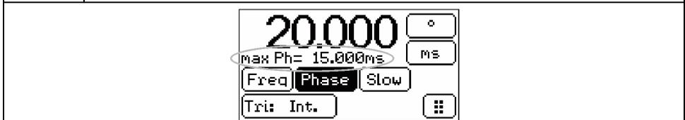
**i** Wird eine Verzögerung in Millisekunden eingestellt, die einer Phasenverschiebung größer  $540^\circ$  entspricht, erscheint in der zweiten Zeile des Displays im Wechsel mit der Standard-Anzeige ein entsprechender Hinweis (siehe Bild).
