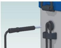
Aus Sicherheitsgründen muss der Erdstecker auf ganzer Länge eingesteckt werden.
