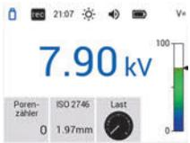
Wenn die Prüfspannung als aktiver Bereich gewählt ist (blaue Ziffern), kann mittels der Pfeiltasten die Spannung direkt eingestellt werden. Die eingestellte Spannung wird automatisch übernommen.
