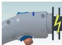
Die LED-Anzeige im Handgriff wechselt auf Blau, die Hochspannung ist aktiviert, solange der Sicherheitstaster gedrückt bleibt.
