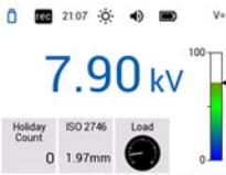
Si la tension d'essai est sélectionnée comme zone active (chiffres bleus), la tension peut être réglée directement à l'aide des touches fléchées. La tension réglée est automatiquement prise en compte.
