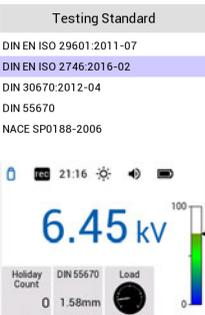
La norme de contrôle utilisée peut être sélectionnée en appuyant longuement sur le widget.
