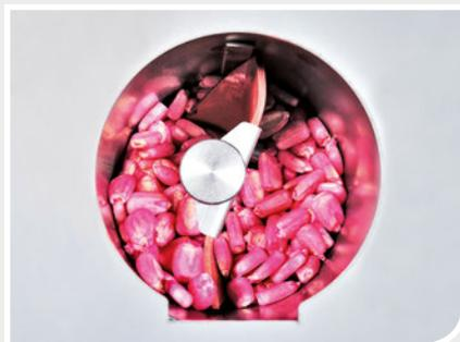
Das Beizgerät MZB 2600 zeichnet sich durch eine hohe Wiederholgenauigkeit und somit gleichmäßige Benetzung mit unterschiedlichsten Beizmitteln aus. Ermöglicht wird diese hohe Beizqualität u.a. durch die Dosierung mittels Schlauchdosierpumpe. Die integrierte Absaugeinrichtung inkl. Abluftschlauch verhindert eine Belastung der Umgebungsluft mit Beizstäuben oder Beizdämpfen.
