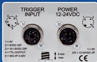
Anschlüsse: links Trigger, rechts Spannungsversorgung
